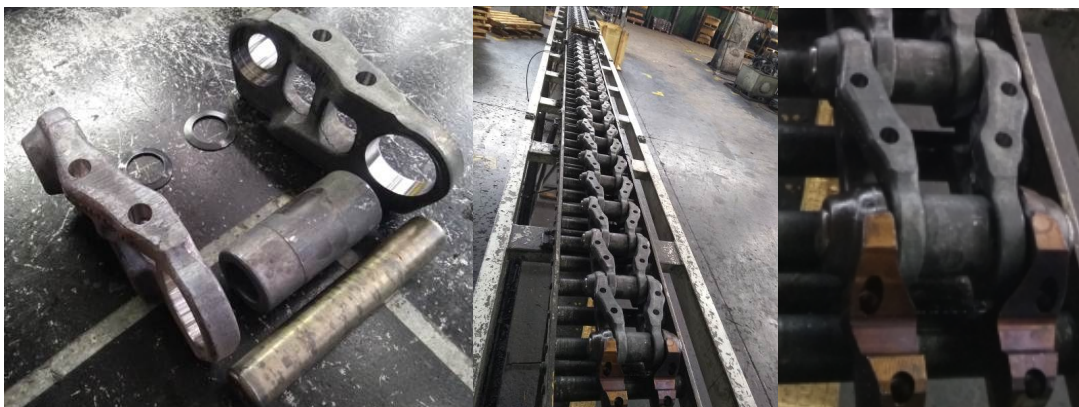
Figura 3,4 e 5 – Respectivamente: componentes das correntes de esteiras; corrente de rolamento sendo montada; detalhe da corrente de rolamento montada com as buchas.
